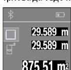
Първата измерена стойност се показва в горната част на дисплея. След приключване на второто измерване площта се изчислява автоматично и се показва. Най-отдолу на дисплея стои резултатът, над него - стойностите от отделните измервания.
