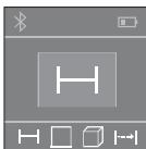
След включване измервателният уред се намира в режим за измерване на дължини. Други функции за измерване можете да настроите чрез неколкократно натискане на бутона **(2)** (вж. „Функции за измерване“, Страница 137).
