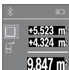
Натиснете бутона (4), за да стартирате ново измерване на площ. Установете повърхността съгласно раздел "Измерване на повърхности" (вж. „Измерване на площ“, Страница 137). За да приключите събирането, натиснете бутона (4). За да прибавите други измерени стойности, натиснете отново бутона (1) [+] и т.н.
